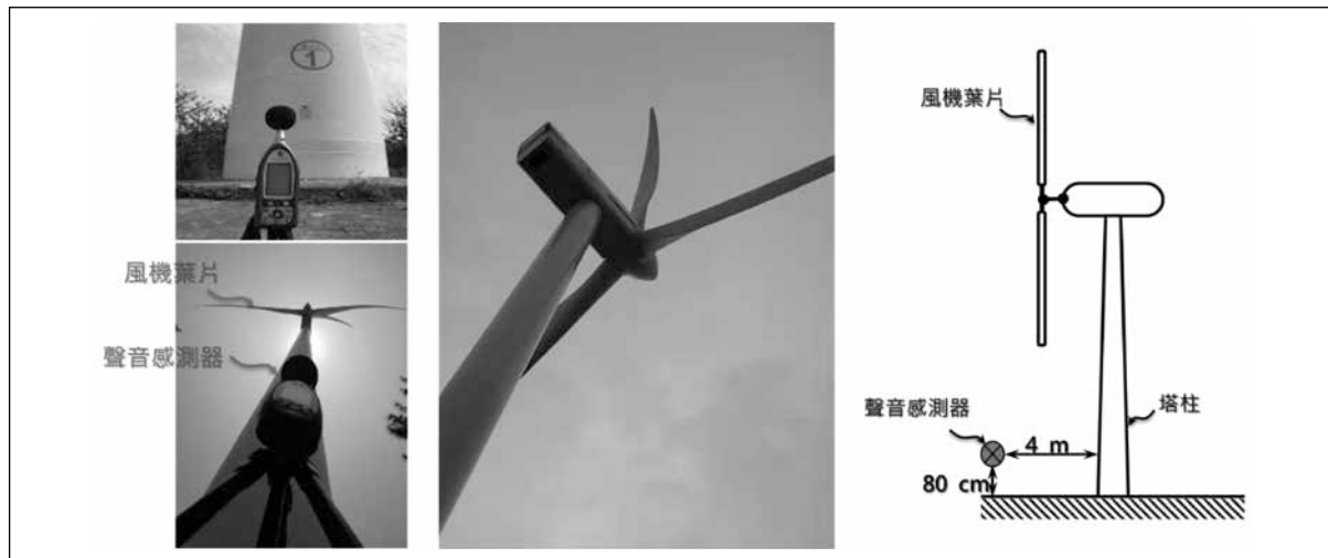
圖二 風機葉片轉動聲音的量測位置
